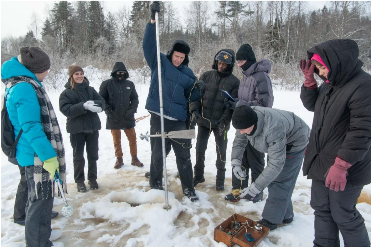
Измерение скоростей течения реки Луги гидрометрической вертушкой. Фото Е.Э. Елинера, 2026 г.
