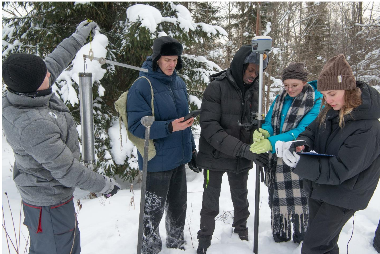
Съёмка снежного покрова на зимнем комплексном профилировании. Съёмка высот – СДК ГНСС. Фото Е.Э. Елинера, 2026 г.
